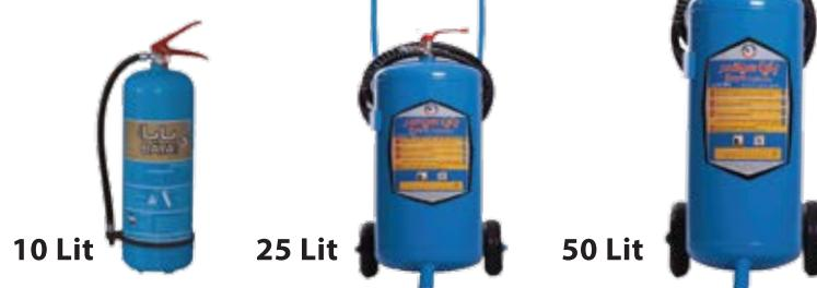
خاموش‌کننده‌های آب و گاز (نیتروژن با خلوص ۹۹.۹ درصد) تحت فشار این گروه از خاموش‌کننده‌های دستی معمولاً دارای ظرفیت ۹ لیتری یا بیشتر آب خالص می‌باشند و برای استفاده در آتش‌سوزی‌های گروه A مورد استفاده قرار می‌گیرند. یکی از مشکلاتی که این نوع خاموش‌کننده‌ها دارند آن است که در مناطقی که درجه هوای آن کمتر از ۴ درجه سانتیگراد می‌باشد به دلیل يخ زدن آب غیرقابل استفاده می‌باشد.
