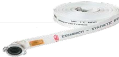
بافته شده از الیاف پلی استر که در مقابله سایش مقاوم و با ایجاد اصطکاک کم و انعطاف پذیری بالا راحتی خاصی را برای کابر فراهم می‌سازد. لایه داخلی آن به صورت لاستیکی از جنس EPDM (اتیلن، پروپیلن، داین) ساخته شده است و در برابر حرارت بالا و رطوبت و برخی از مواد شیمیایی مقاوم می‌باشد. مورد استفاده نیروهای آتش نشانی و افراد کار آزموده در مبارزه با آتش سوزی و همچنین استفاده در جعبه های فایر باکس. ارائه شده در سایزهای ۱/۲ و ۲ و ۳ و ۴ در حلقه های ۲۰، ۲۵ و ۱۰۰ متری به رنگ سفید.
