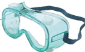
جنس لنز از پلی کربنات با خاصیت مقاومت در برابر پرتوهای UV بندهای الاستیکی راحت بدنه سبک و بادوام از جنس پلی وینیل به رنگ سبز روشن دارای چهار سوپاپ تخلیه هوا که از بخار گرفتگی جلوگیری می‌کند.
