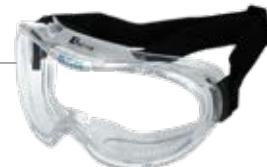
جنس لنز از پلی کربنات ضد خش با خاصیت مقاومت در برابر پرتوهای UV بندهای قابل رگلاز الاستیکی راحت که جاذب عرق می‌باشد بدنه سبک و بادوام ژلاتینی جاذب انرژی برای منطبق شدن بهتر با صورت و بهبود جذب ضربه دارای چهار سوپاپ تخلیه هوا.
