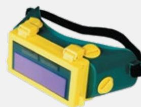
این محصول با دارا بودن قابلیت تغییر ناگهانی میزان تیرگی شیشه ایمنی محافظ چشم، نیاز به تغییر مکرر شیشه محافظه به صورت دستی را از بین می برد طراحی به صورت گاگل که راحتی و ایمنی کامل را برای شما فراهم می کند. بدنه سبک و بادوام از جنس پلی وینیل به رنگ سبز تیره دارای چهار سوپاپ تخلیه هوا بندهای الاستیکی راحت که عینک را بر روی صورت شخص استفاده کننده فیکس نگه می دارد
