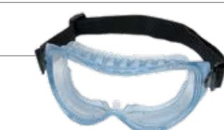
جنس لنز از پلی کربنات ضد خش و ضد بخار، محافظه ۹۹٪ در مقابل پرتوهای UV بند های قابل رگلاز الاستیکی راحت، جاذب عرق بدنه سبک، بادوام ژلاتینی جاذب انرژی برای منطبق شدن بهتر با صورت و بهبود جذب ضربه دارای سوباپ های تخلیه هوا که از بخار گرفتگی جلو گیری در عین حال از ورود ذرات ممانعت می کند
